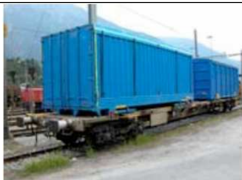
Exemple de wagon plat (ici avec deux caisse mobile pouvant chacune être chargée sur un camion) .
