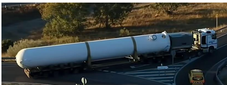
Figura 42. Trasporto di un serbatoio di idrogeno a 60 bar
